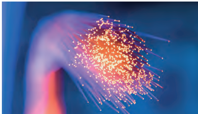
Fibra óptica é um filamento flexível e transparente fabricado a partir de vidro ou de plástico moldado cujo comprimento do diâmetro mede alguns micrometros. É um excelente condutor de luz, de imagens ou de impulsos codificados.
