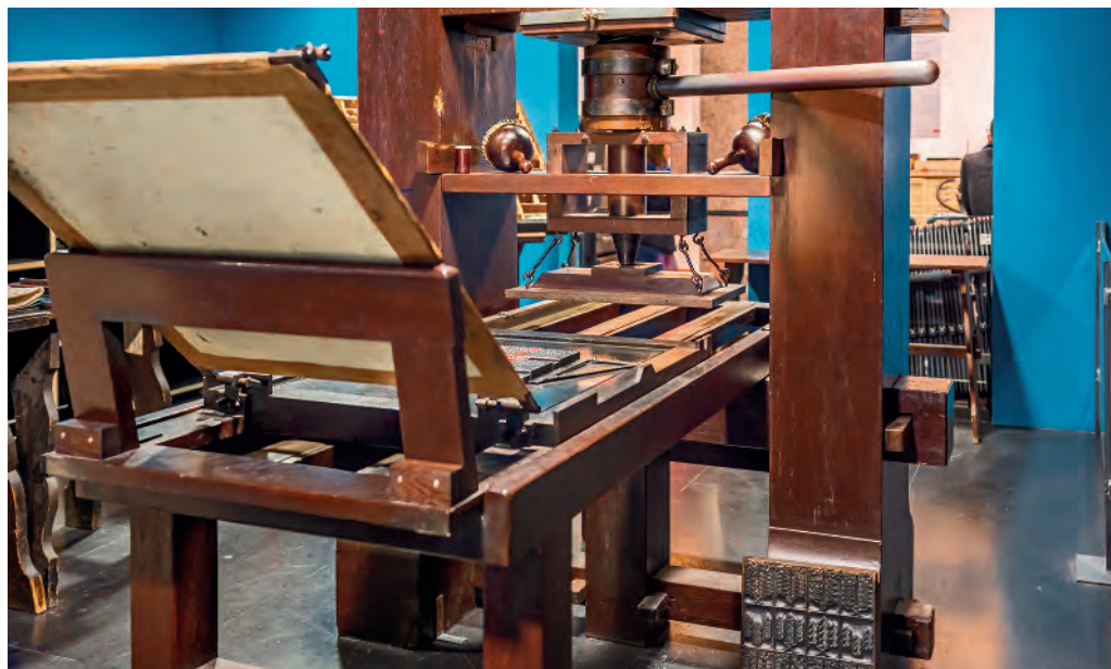
Réplica da imprensa criada por Johannes Gutenberg no Museu Gutenberg em Mainz, na Alemanha. Fotografia de 2020. Gutenberg aperfeiçoou a técnica de impressão com caracteres (tipos) móveis, conhecida desde a Antiguidade na China e no Japão.
